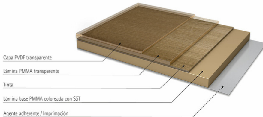
Estructura esquemática de la lámina de exteriores RENOLIT EXOFOL FX
